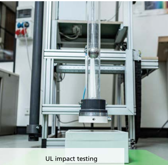
IK level impact testing
