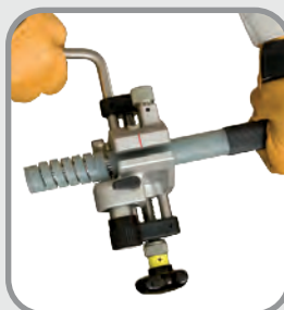
Îndepărtare izolație PVC
